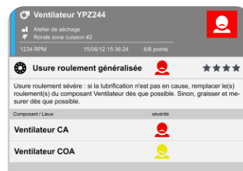
Vue Détaillée défaut et localisation
